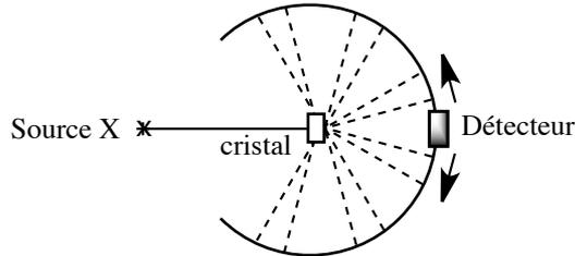
FIGURE 6.1 – Principe de la diffraction des rayons X.
