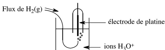
FIGURE 9.8 – Électrode à dihydrogène
