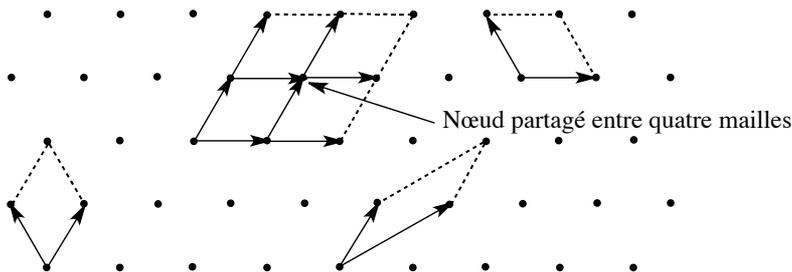
FIGURE 6.5 – Mailles simples dans un réseau bidimensionnel
