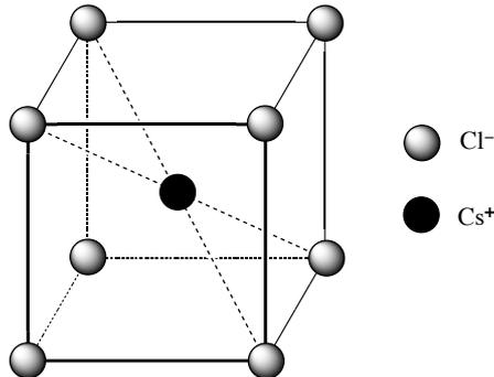
FIGURE 6.42 – Structure du chlorure de césium
