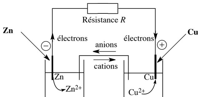
FIGURE 9.5 – Fonctionnement de la pile DANIELL
