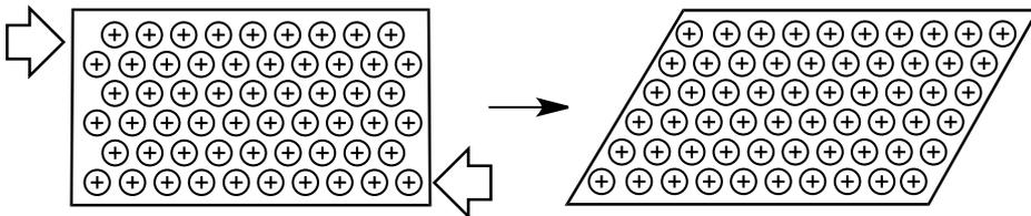
FIGURE 6.11 – Glissement des plans dans un métal
