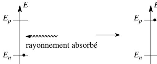
FIGURE 2.10 – Processus d'absorption
