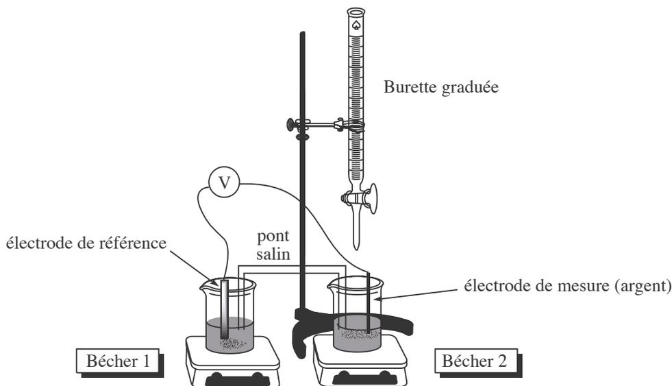
FIGURE 9.26 – Dispositif expérimental
