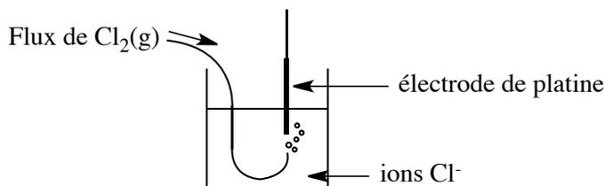
FIGURE 9.7 – Électrode à dichlore
