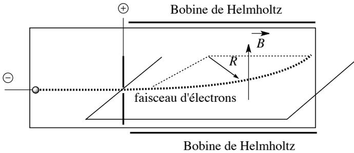
FIGURE 2.2 – Mesure du rapport  $e/m$  de l'électron
