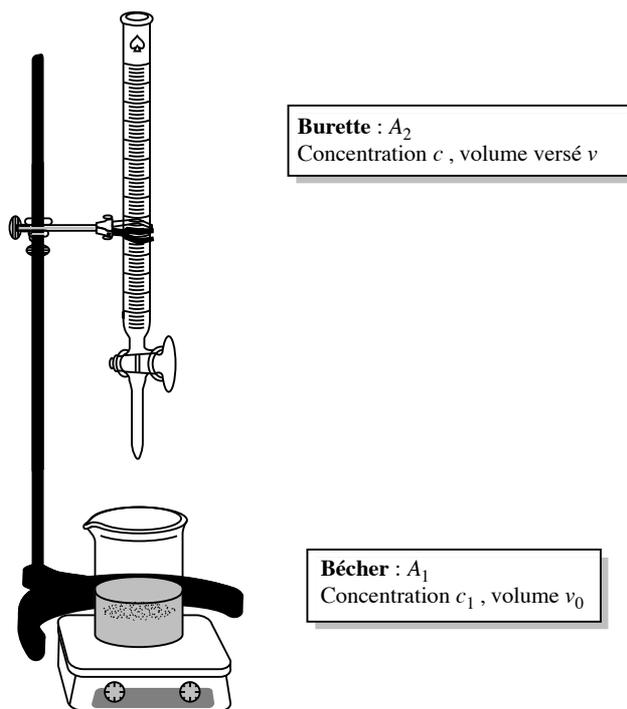
FIGURE 7.12 – Dispositif expérimental
