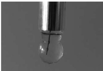
FIGURE 7.13 – Photo d'une électrode de verre
