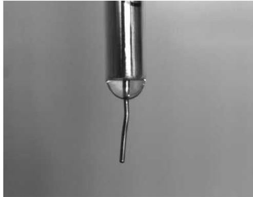
FIGURE 9.10 – Photo d’une électrode de platine
