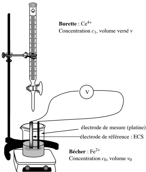
FIGURE 9.21 – Dispositif expérimental
