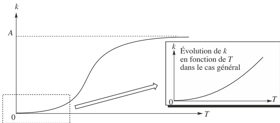
FIGURE 4.13 – Dépendance en température d'une constante de vitesse
