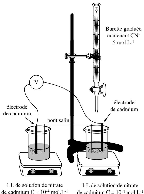
Dans le compartiment (2), on verse des volumes  $V_{\text{CN}^-}$  de solution de cyanure de potassium de concentration molaire  $c_0 = 5,00 \text{ mol.L}^{-1}$ . On mesure la force électromotrice  $e = E_1 - E_2$  ( $E_i$  représente le potentiel de l'électrode de cadmium dans le compartiment  $i$ ) de la pile formée
