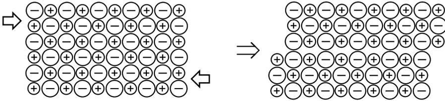
FIGURE 6.13 – Glissement des plans dans un cristal ionique
