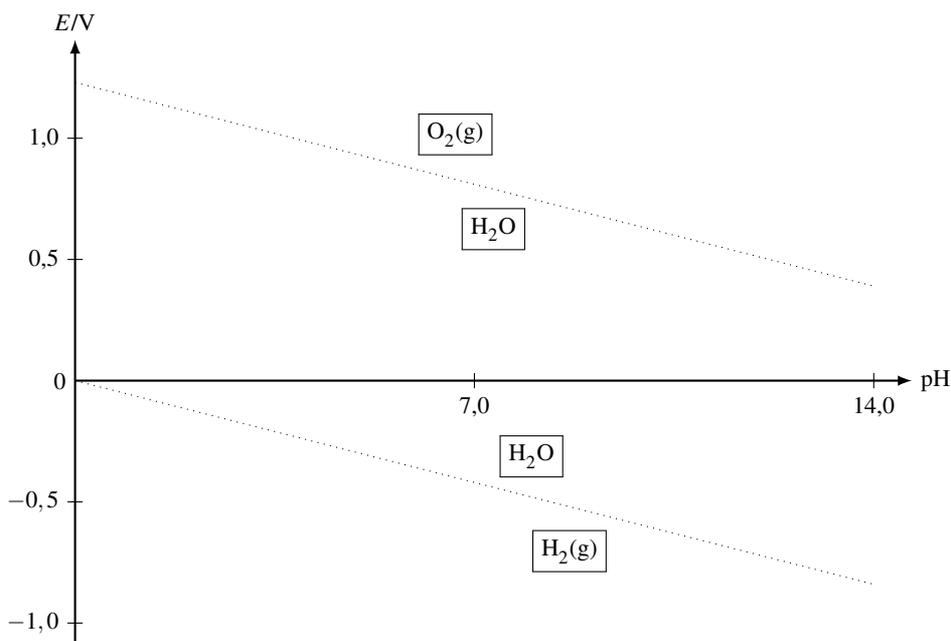
FIGURE 10.1 – Diagramme  $E$ -pH de l'eau
