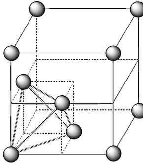
FIGURE 6.28 – Site tétraédrique dans la structure *c.f.c.*
