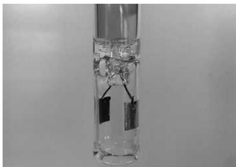
FIGURE 5.15 – Cellule conductimétrique
