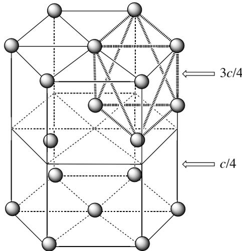
FIGURE 6.34 – Site octaédrique dans la structure *h.c.*
