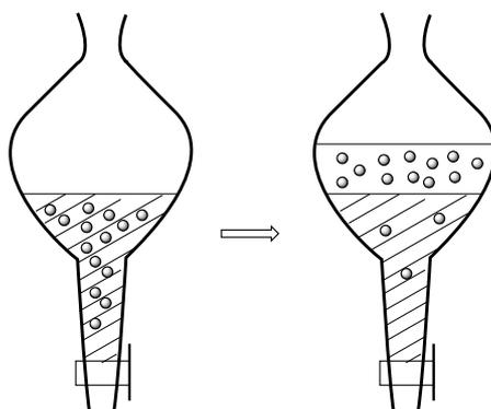
FIGURE 5.18 – Extraction liquide-liquide (ampoule à décanter)
