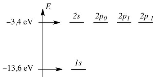
FIGURE 2.13 – Orbitales atomiques des deux premiers niveaux d'énergie
