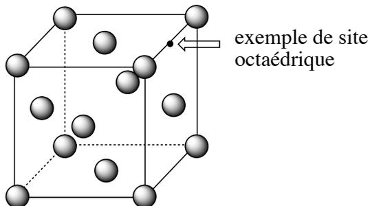
Par refroidissement rapide (trempe) de l'acier austénitique, la structure cristallographique du fer évolue (et devient une structure cubique centrée). Des atomes de carbone sont toujours présents entre les atomes de fer, ce qui engendre une structure quadratique plutôt que cubique. L'alliage alors rencontré est la *martensite* (ou acier martensitique).
