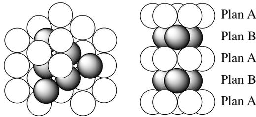
FIGURE 6.20 – Empilement A-B-A-B-A-B
