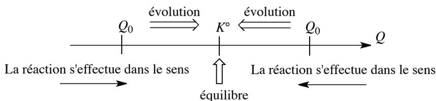
FIGURE 1.10 – Évolution d'un système vers l'équilibre chimique
